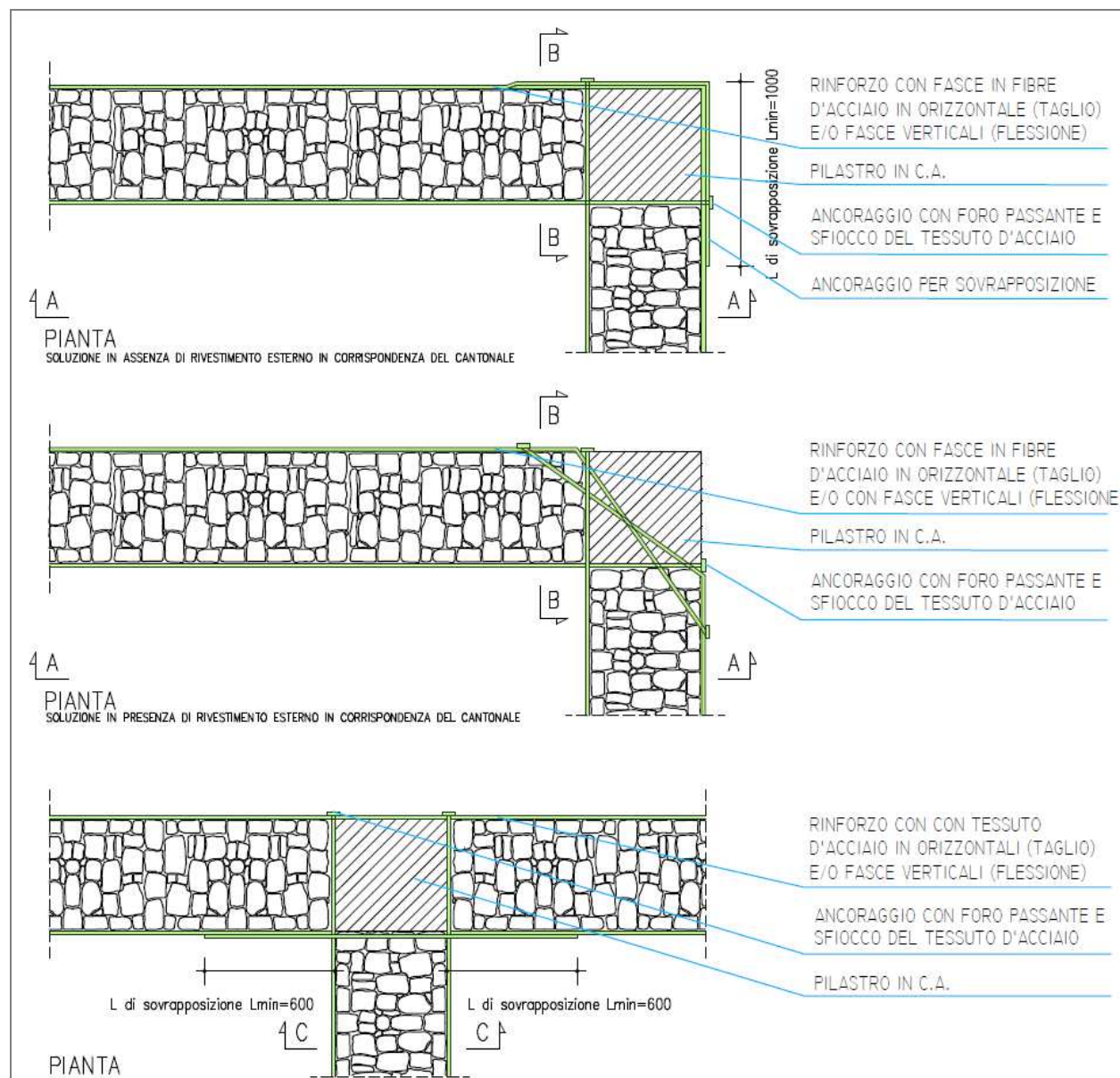
Figura 4-8: pianta rinforzo a taglio e flessione con tessuti in fibra di acciaio su muratura, sez. d'angolo e interna
